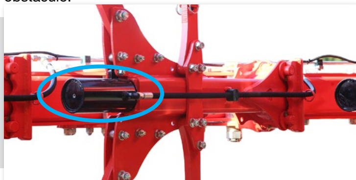
1º e 4º corpo com diâmetro maior do cilindro.
