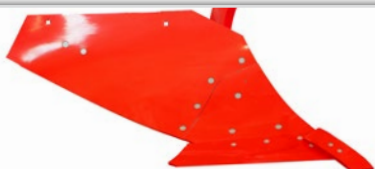
MP6WC - Aiveca cheia, cilíndrica, ideal para solos muito argilosos. (Profundidade de trabalho 30 – 45 cm).
