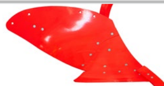
MP6WS - Aiveca cheia, semi-helicoidal, ideal para solos muito argilosos. (Profundidade de trabalho 30 – 45 cm).
