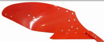
MP4WN - Aiveca cheia, semi-helicoidal, ideal para solos pesados/húmidos. (Profundidade de trabalho 20 – 30 cm).
