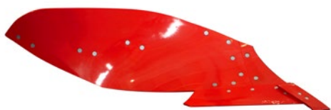
MP4WD - Aiveca cheia, semi-helicoidal, ideal para solos pesados/húmidos, para tratores de rodas largas ( \leq 800 mm). (Profundidade de trabalho 15 – 30 cm).
